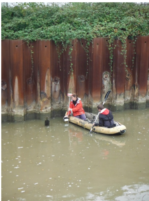
Figure 69 : Réalisation de profils en travers et en long des jalles en amont des ouvrages.
