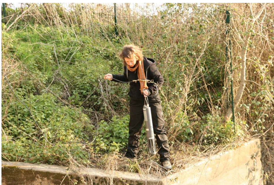
Figure 68: Mesures de la turbidité grâce à une sonde multiparamètres.
