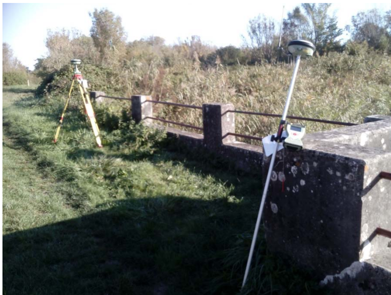
Figure 81 : GPS différentiel avec mobile (premier plan) et pivot (second plan). Source : MIGADO, 2015.
