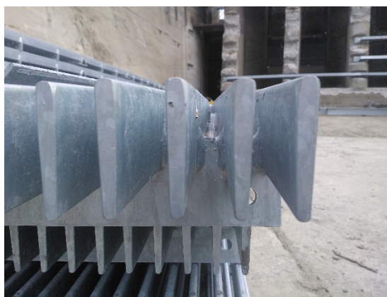
Photo 8 : Forme « aile d'avion » des barreaux composant les nouveaux plans de grille
