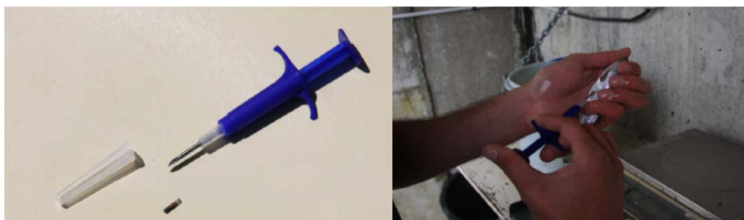
Photo 4 : Seringue et marque pit-tag Photo 5 : Smolt lors de l'introduction de la marque
