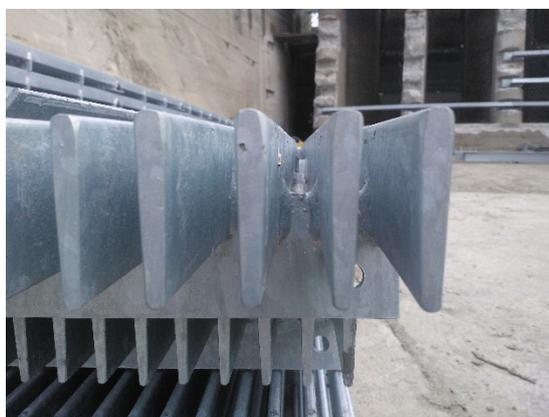
**Photo 8 : Forme « aile d'avion » des barreaux composant les nouveaux plans de grille**
