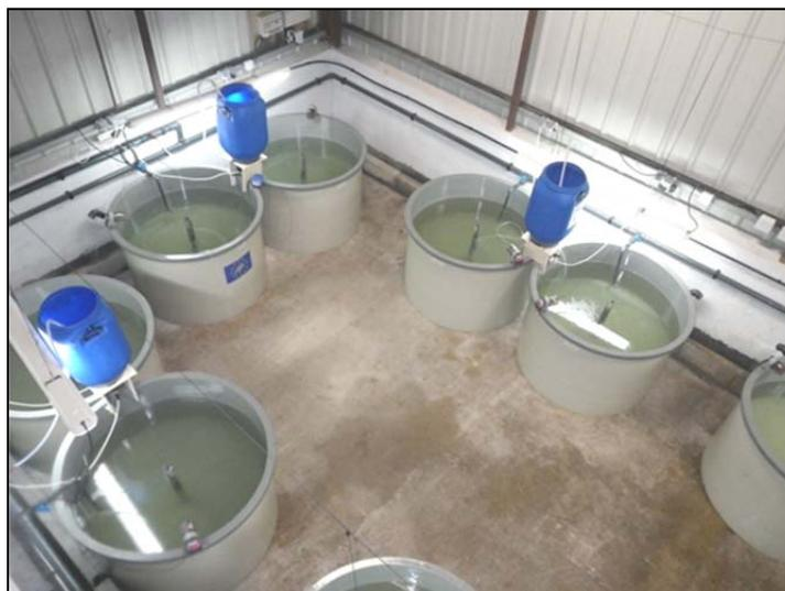
**Figure 23 : Photographie des structures d'élevage larvaire en fonctionnement.**
