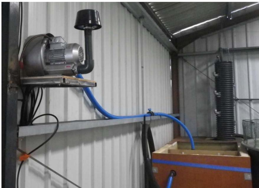
**Photographie 7 : Dispositif d'oxygénation de l'eau en circuit fermé.**
