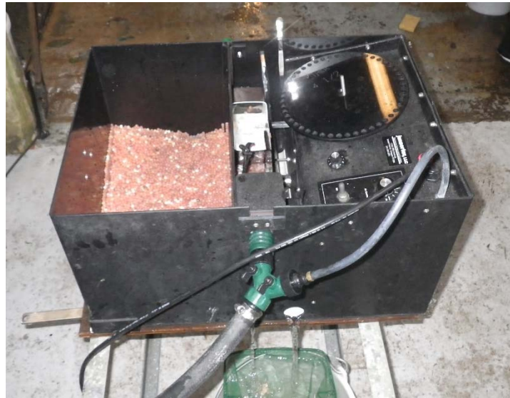
Photographie 5 : Tri automatique des œufs pour éliminer les morts.
