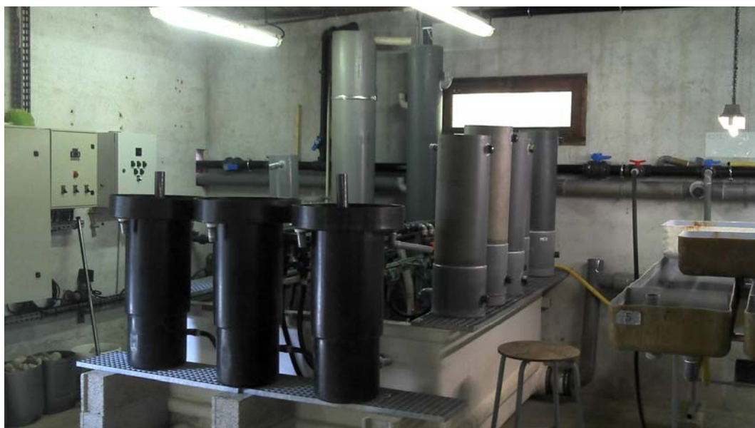
Photographie 3 : Circuit fermé principal et incubateurs à œufs verticaux.
