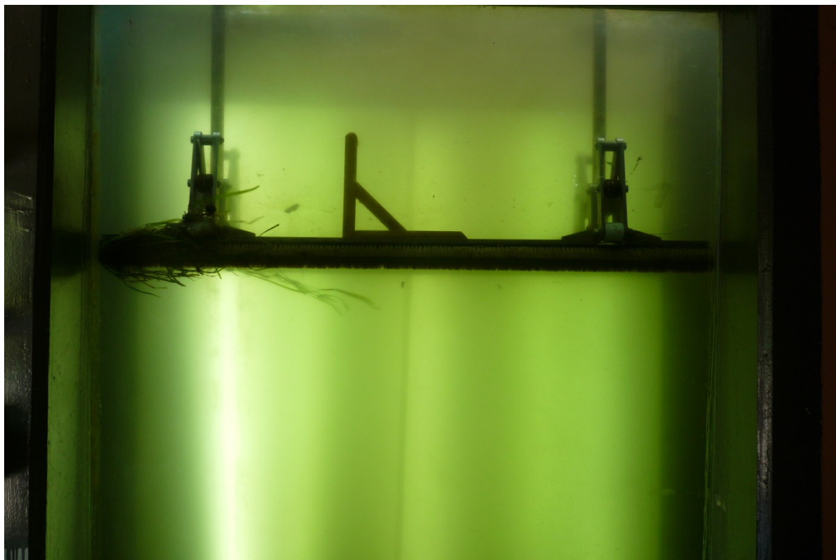
Figure 5 : Vue du système de nettoyage automatique des vitres du local vidéo de Golfech installé en 2011
