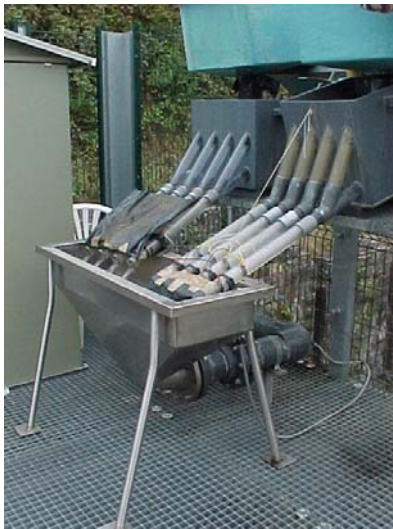
Photo 10 : Tubes du compteur à anguilles
