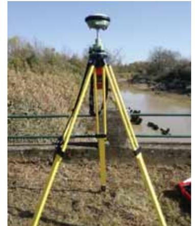
Figure 56 : Photographie du trépied du GPS différentiel
