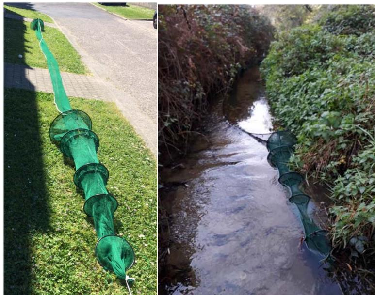
**Figure 66 : Verveux utilisé pour les suivis.**
