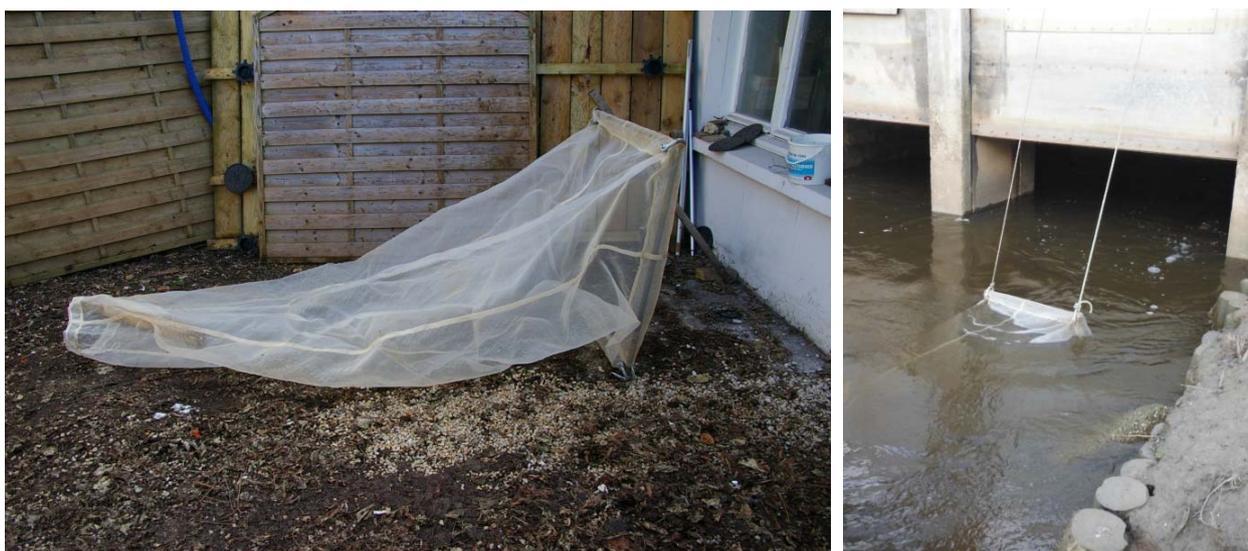
Figure 31 : Cadre de pêche utilisé pour le suivi du flux entrant de civelles
