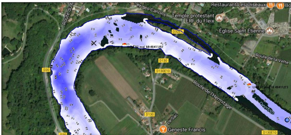
**Figure 33 : Exemple de vue bathymétrique de la Dordogne réalisée avec un échosondeur double faisceau. Secteur du Fleix.**
