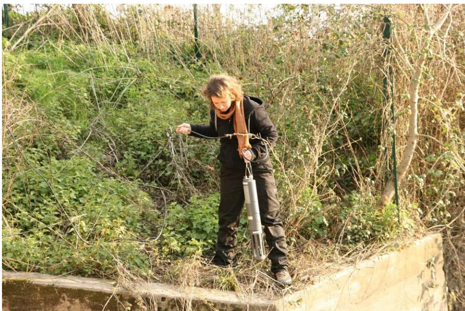
**Figure 48 : Mesures de la turbidité grâce à une sonde multiparamètres.**
