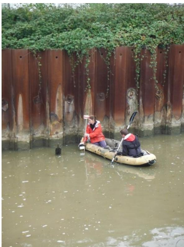
**Figure 49 : Réalisation de profils en travers et en long des jalles en amont des ouvrages.**
