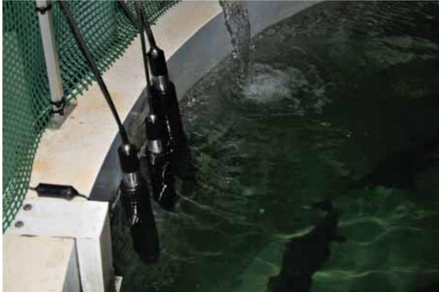
**Figure 11 : Sondes automatiques (oxygène, température, salinité, pH) installées dans les bassins de reproduction (BR) afin de suivre l'évolution des paramètres.**
