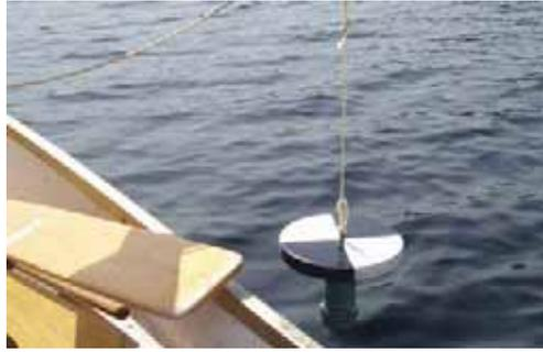
**Figure 32 : Cliché du disque Secchi utilisé pour déterminer la transparence de l'eau (CRE Laurentides, 2009)**
