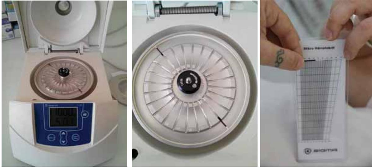
Figure 20 : Centrifugeuse, capillaires et abaque utilisés pour la lecture des hémocrites
