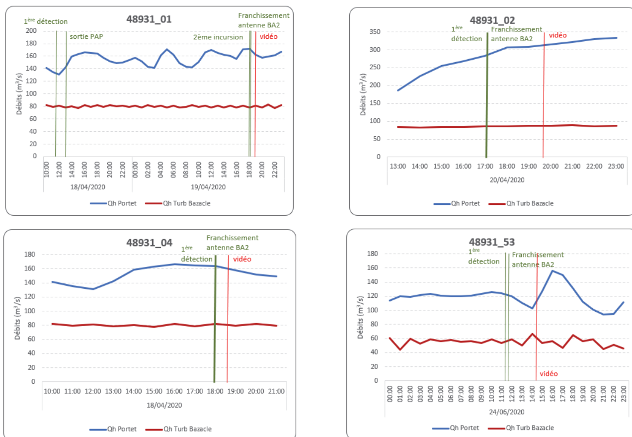
Figure 50 : Détections des saumons aux antennes RFID du Bazacle et contrôle vidéo pour les individus ayant franchi l'aménagement
