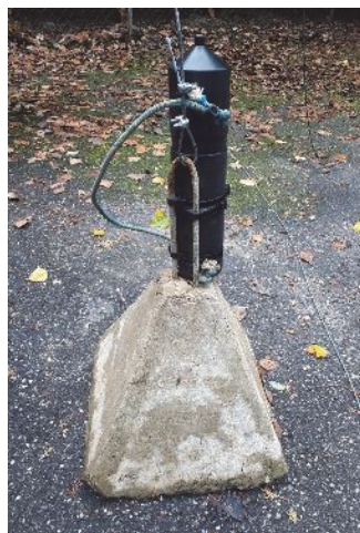
Photo 20 : Hydrophone et exemple d'installation d'hydrophone avec son lest
