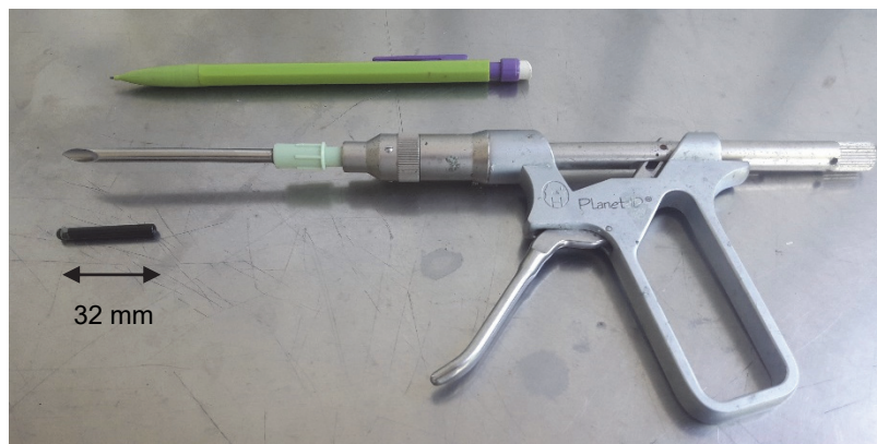
Photo 15 : Tag RFID de 32 mm et son pistolet de marquage
