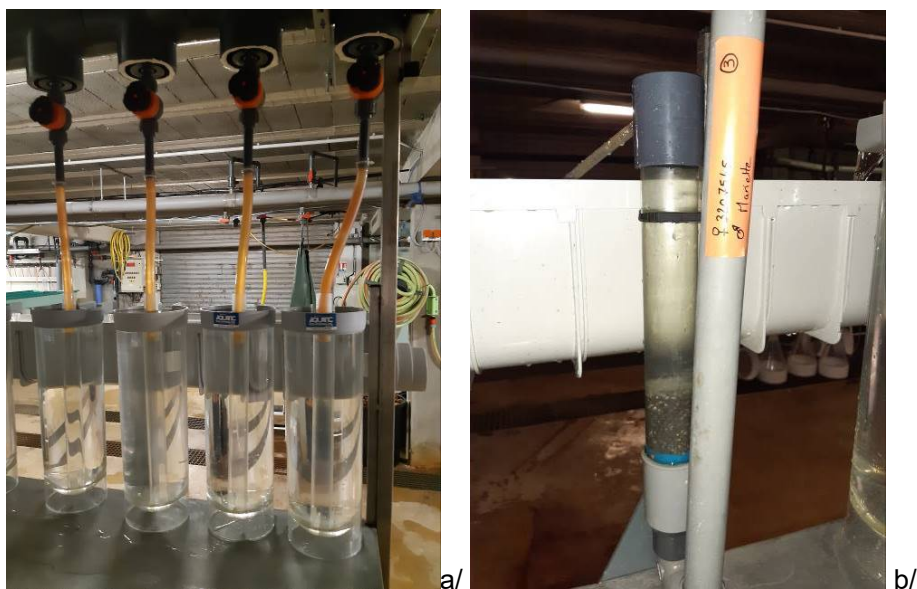
Figure 35 : Jarres d'incubation MacDonald prévues (a) et utilisation de petites jarres pour des petits lots (b)
