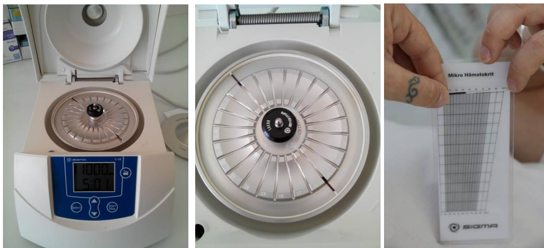
Figure 37 : Centrifugeuse, capillaires et abaque utilisés pour la lecture des hématocrites
