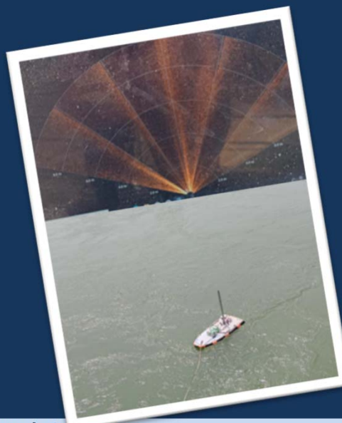
Drone avec caméra acoustique à Golfech et image obtenue
