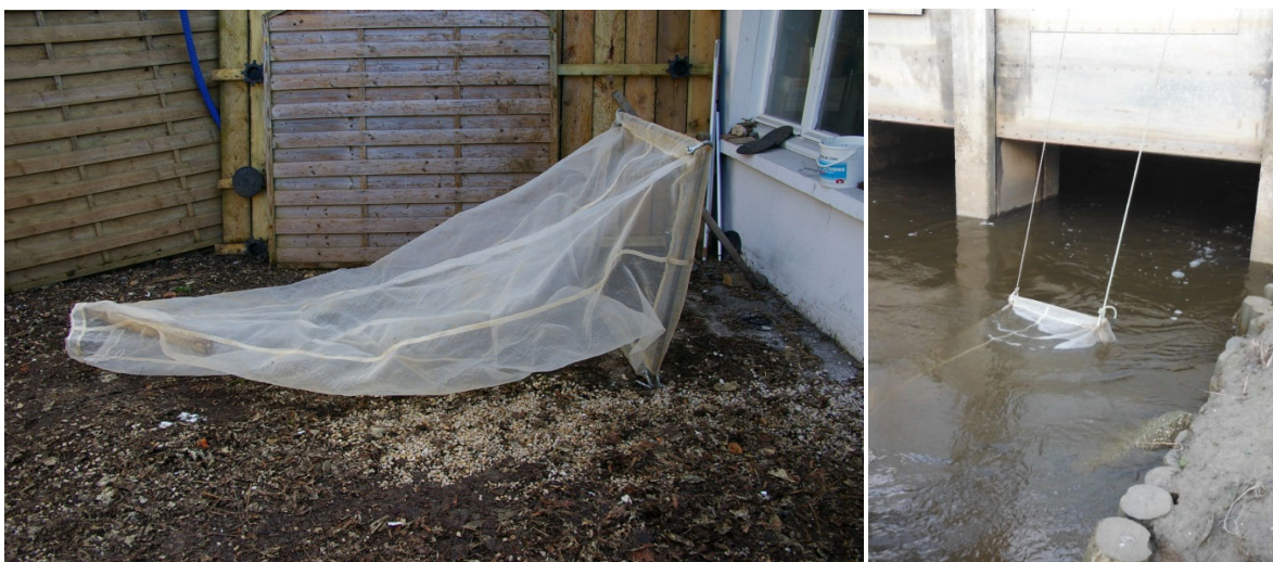
Figure 1 : Cadre de pêche utilisé pour le suivi du flux entrant de civelles
