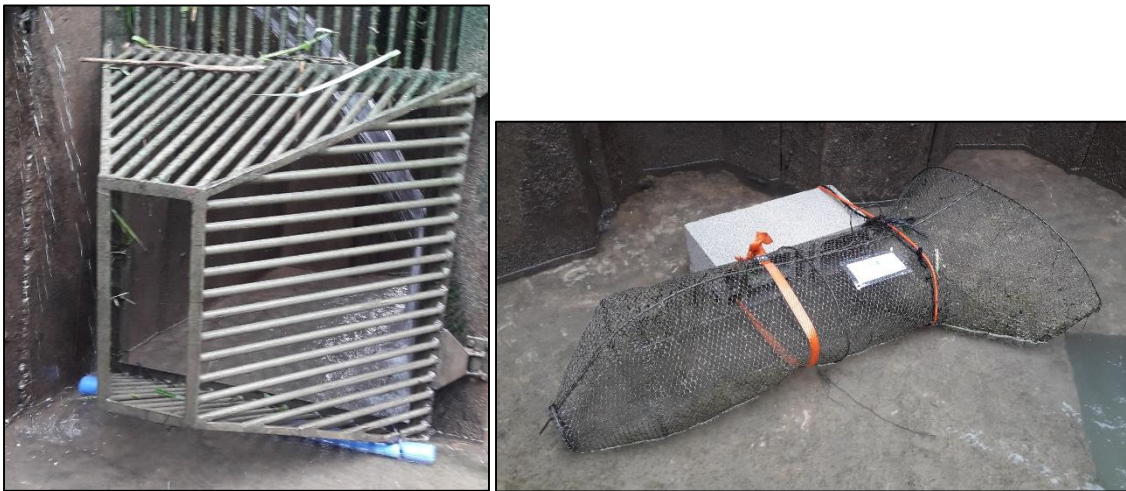
Figure 35 : Illustration du système bloquant sous les grilles entonnoirs (gauche) et d'une nasse installée dans le piège (droite)
