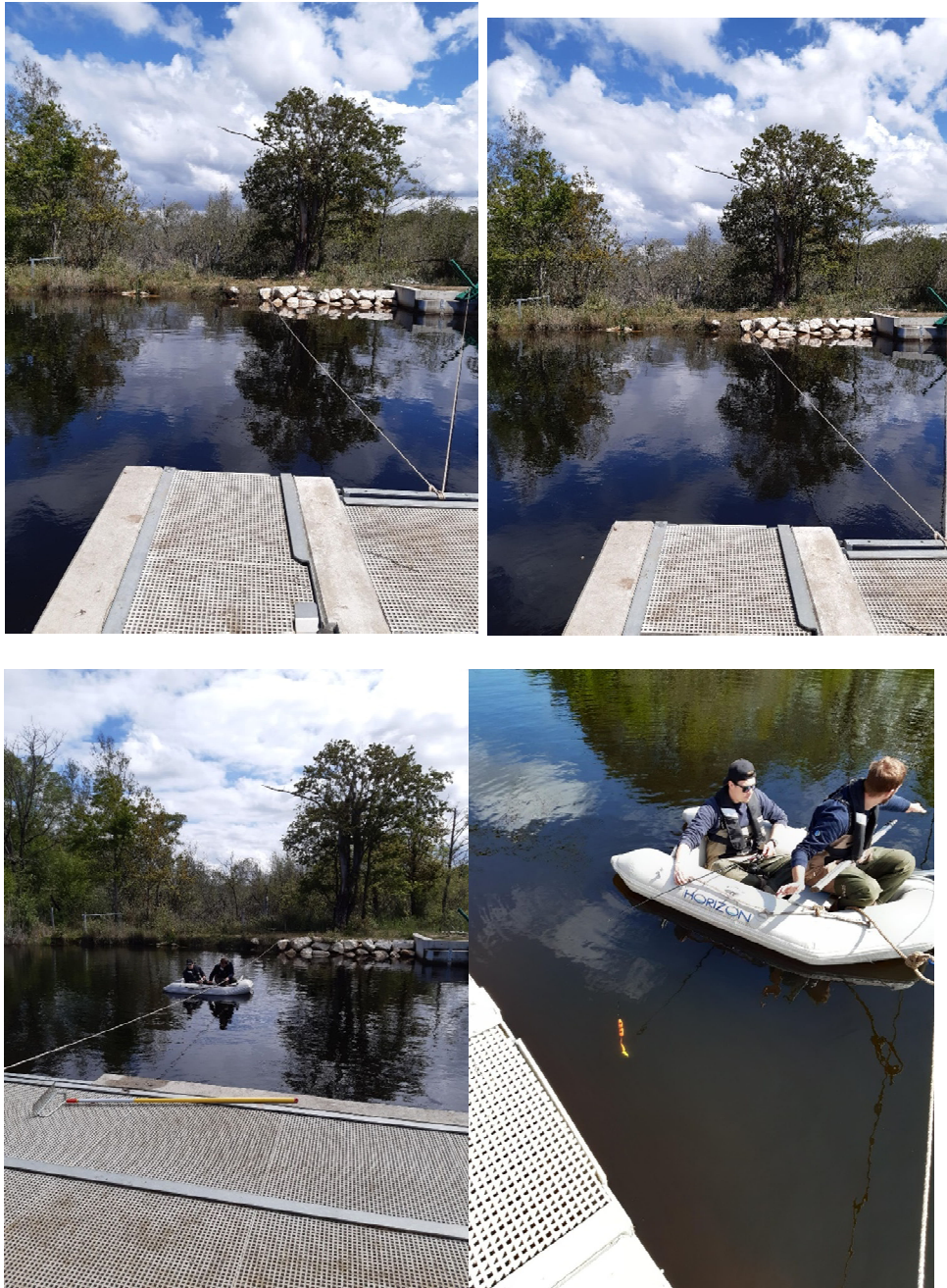
Figure 24 :réalisation des tests avec un leurre pour évaluer le cône de détection de la caméra sonar
