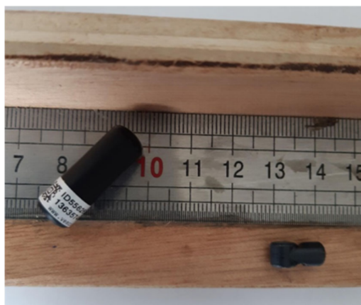
Figure 27 : Marques acoustiques V9 (à gauche) et V5 (à droite)
