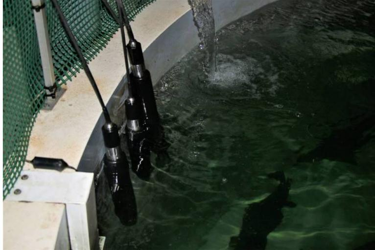
**Figure 12 : Sondes automatiques (oxygène, température, salinité, pH) installées dans les bassins de reproduction (BR) afin de suivre l'évolution des paramètres.**
