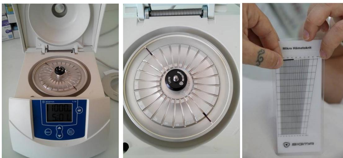
**Figure 38 : Centrifugeuse, capillaires et abaque utilisés pour la lecture des hématocrites**
