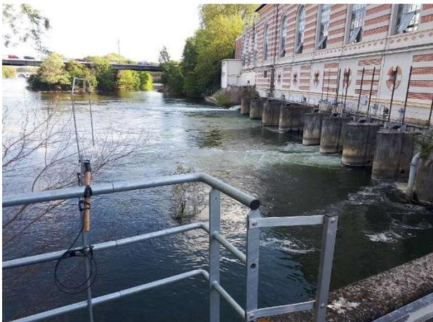
**Photo 33 : Antenne aval (antenne boucle) installée à l'entrée de la passe à poissons de l'usine du Ramier**
