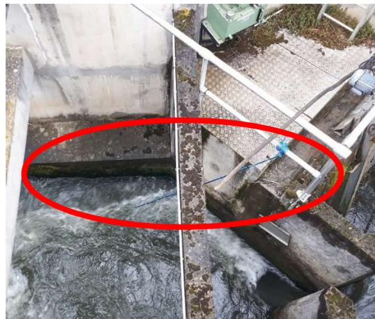
**Photo 34 : Antenne amont (antenne brin) installée en amont de la passe à poissons de l'usine du Ramier**
