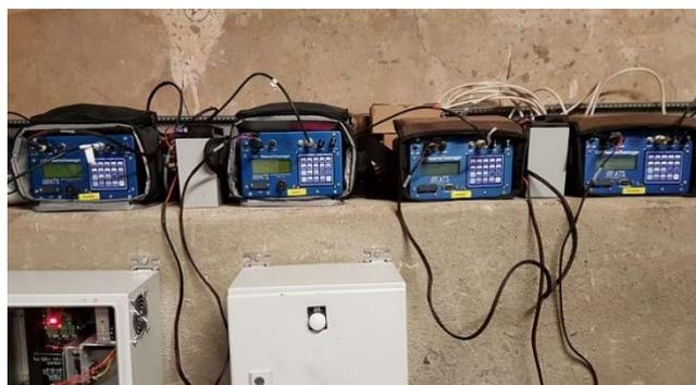
**Photo 31 : Exemples d'installation de récepteur-enregistreurs utilisés à Golfech (à gauche) et au Bazacle (à droite)**
