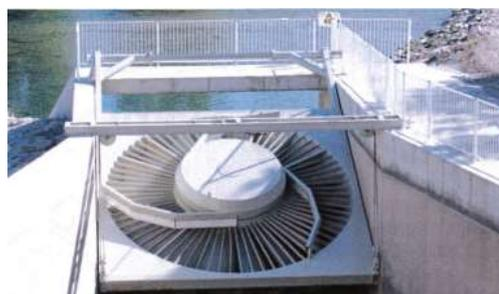
**Photo 17 : Turbine VLH (source : MJ2 Technologies)**
