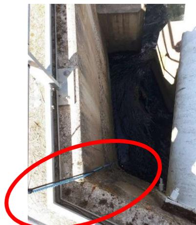
**Photo 36 : Antenne amont (antenne brin) installée en amont de la passe à poissons de l'usine de la Cavaletade**
