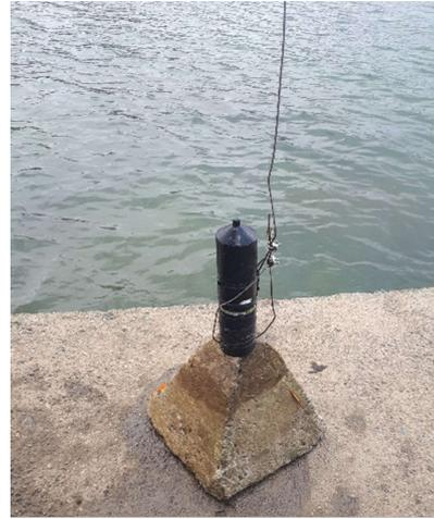
**Photo 29 : Exemples d'installation d'hydrophone avec son lest**
