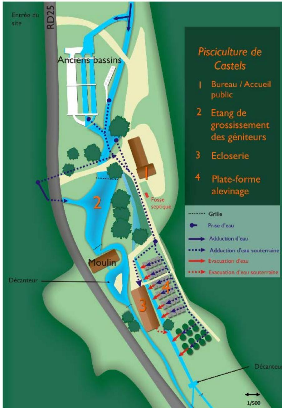
Figure 1 : Plan de la pisciculture de Castels, bâtiments et dispositif de production.
