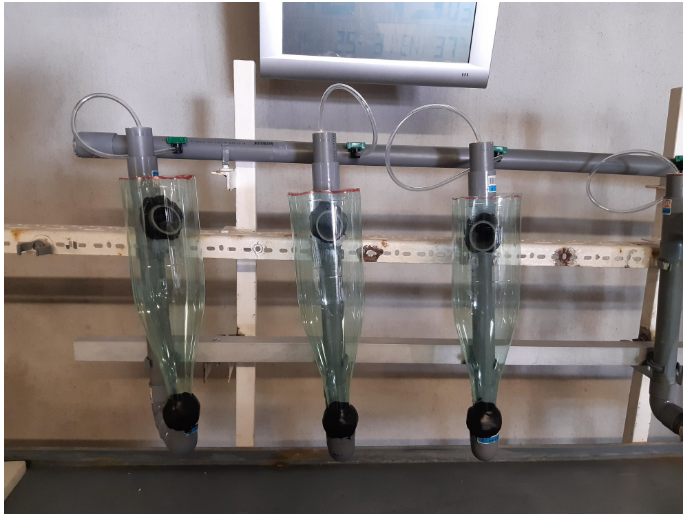
Figure 35 : Nouveaux systèmes de brassage à l'argile fabriqués en 2021 dédiés aux petits lots.
