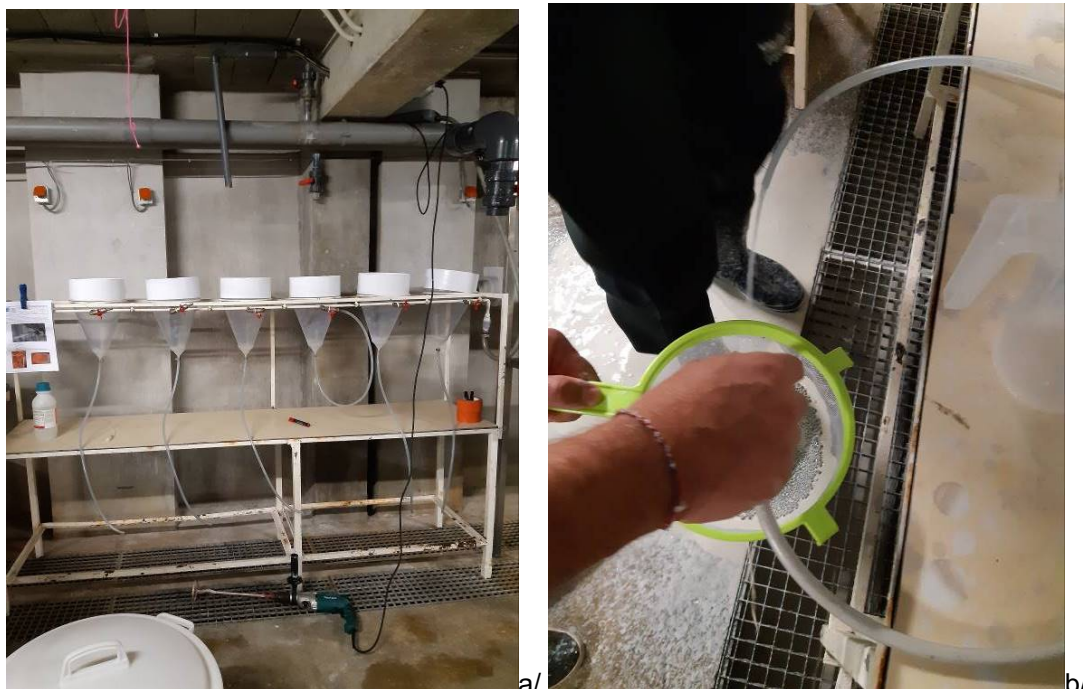
Figure 34 : Préparation des cônes pour passage à l'argile (a) et passage à l'argile (b)
