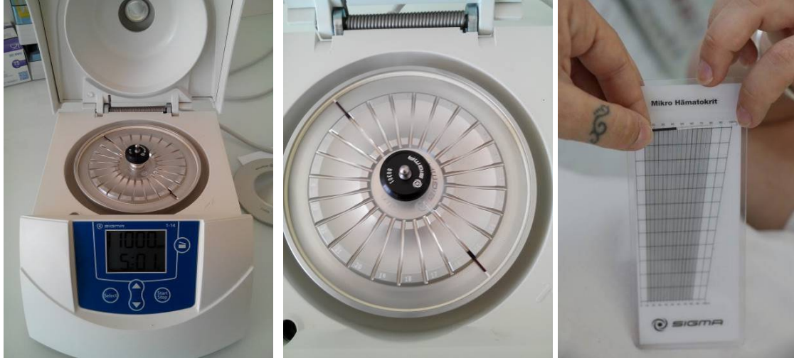
Figure 39 : Centrifugeuse, capillaires et abaque utilisés pour la lecture des hémocrités
