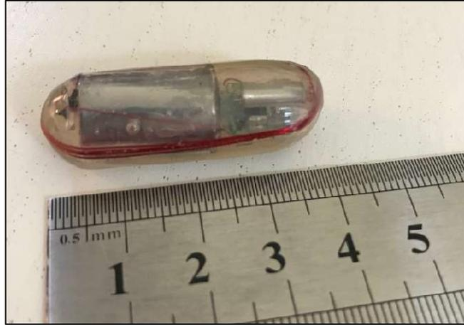
Figure 12 : Marque radio ATS F1210 utilisée pour le suivi
