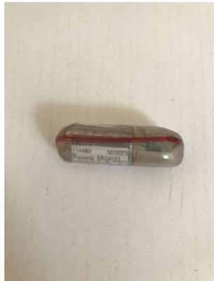
Figure 2 : émetteurs radio ATS série F1210 (ou puce radio).
