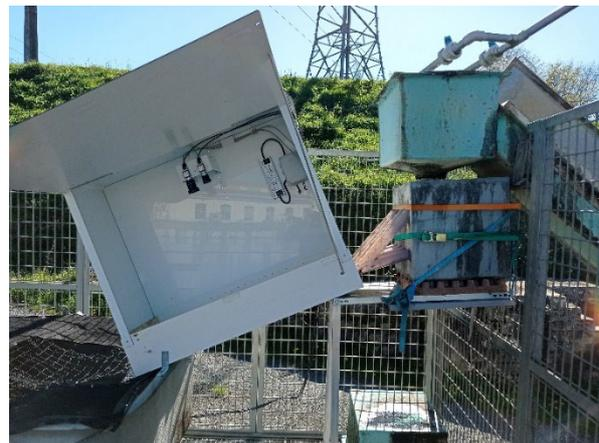
**Photo 10 : Système de comptage automatique HIZKIA installé sur le site de Tuilières**
