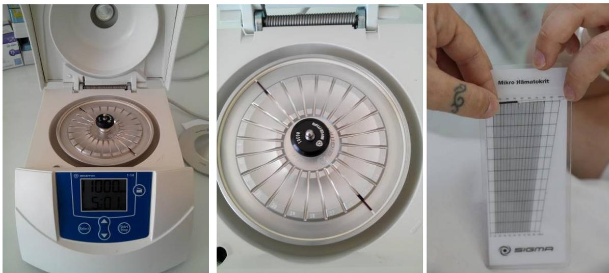
**Figure 22 : Centrifugeuse, capillaires et abaque utilisés pour la lecture des hématocrites**
