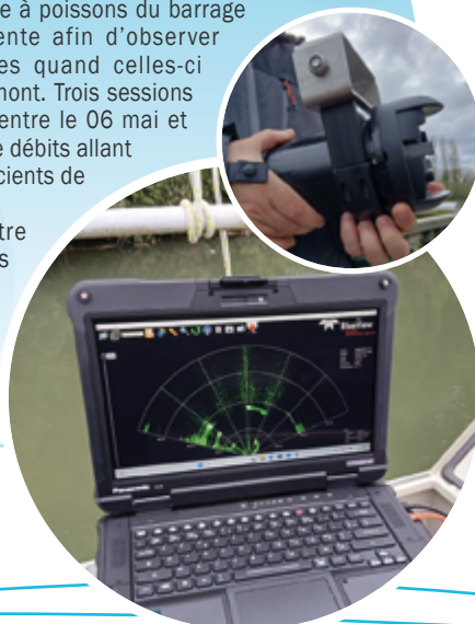
Ordinateur relié à la caméra acoustique (en petite bulle)
