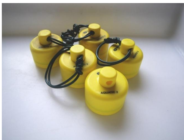
Figure 6 : Thermographes de type Tinytag aquatic 2 – TG4100 utilisés pour le suivi de la thermie.
