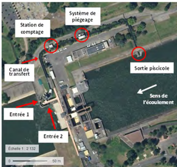
Figure 2 : Vues aériennes de l'usine hydroélectrique de Golfech et du dispositif d'ascenseur à poissons. (Source COURRET et al., 2023)
