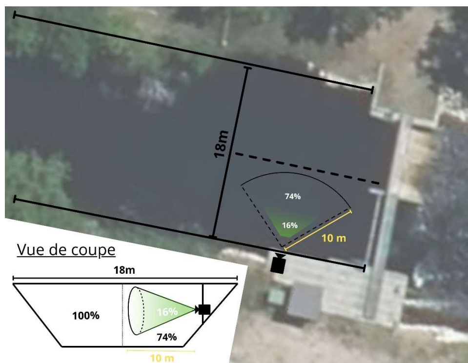
Figure 21 : Plan et coupe du positionnement de la caméra acoustique et schématisation de l'efficacité
