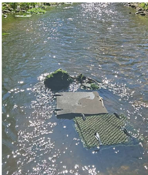
Figure 35 : Paire de flottangs avec et sans mousse
