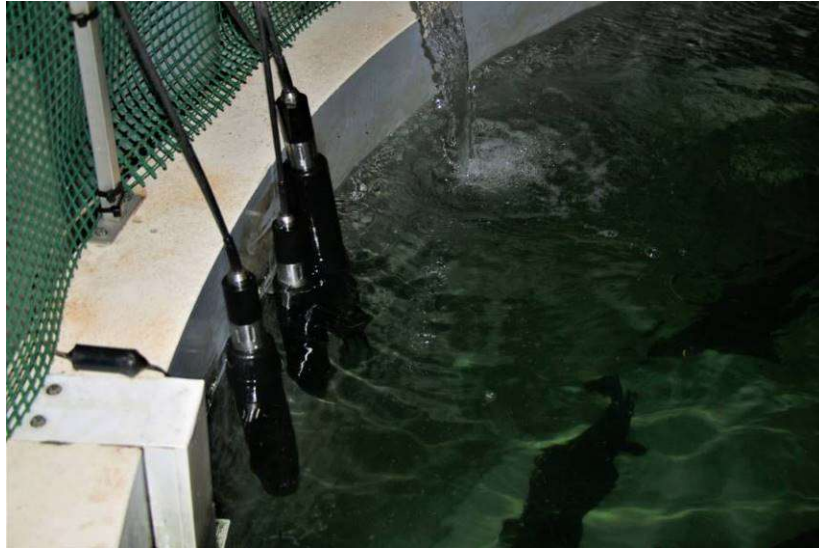
Figure 6 : Sondes automatiques (oxygène, température, salinité, pH) installées dans les bassins de reproduction (BR) afin de suivre l'évolution des paramètres.
