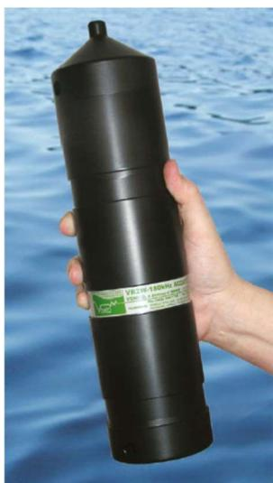
Les hydrophones utilisés (Figure 21) sont des VR2W – 180 kHz. Ils sont fixés à des corps morts et immergés à différents endroits du canal, fixés à la berge par des cordes. Les marques émettent des signaux toutes les 30 sec, et si l'anguille passe devant un hydrophone, ce signal est capté par le récepteur. La zone de réception est d'environ 100m, c'est pourquoi les hydrophones sont assez espacés les uns des autres.
